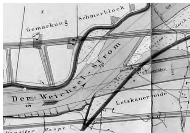
Przegrodzenie wałem przeciwpowodziowym Wisły Gdańskiej Rysunki wg C. Mullera: „Die Regulierung der Weichselmündung”, 1892.
